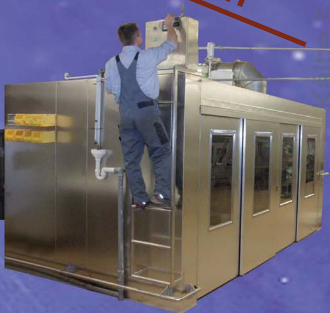
Externe Dampferzeugung sorgt für hygienisch reinen Dampf
